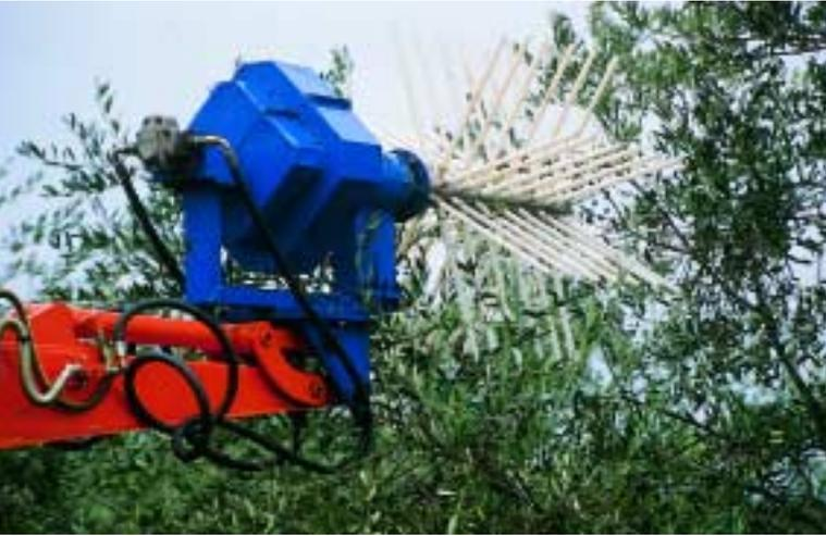
Fig. 24 - Aspo pettinatore assemblato sul braccio dell'escavatore
