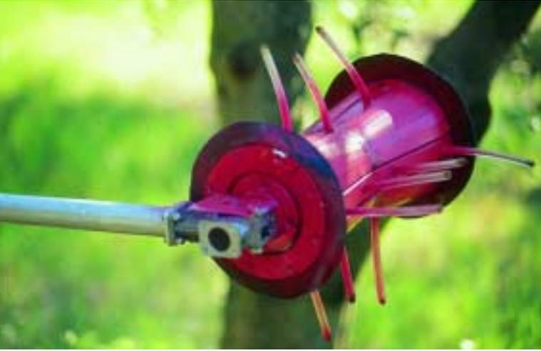
**Fig. 4 - Spazzola ruotante applicata ad un decespugliatore portatile**
