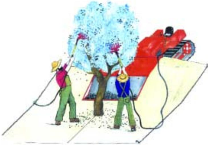
Fig. 6 - Rappresentazione del cantiere di raccolta con pettini pneumatici e ombrello ad apertura semiautomatica
