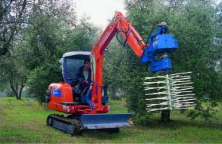
Fig. 25 - Escavatore dotato di aspo di pettinatura
