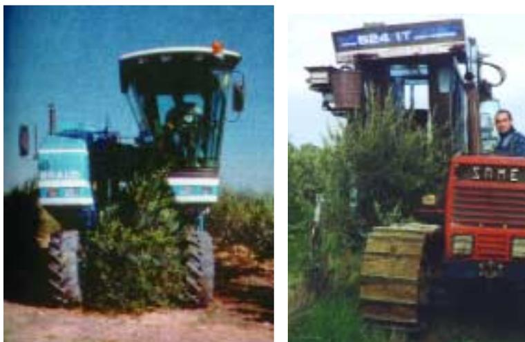
Fig. 27 - Raccolta delle olive con vendemmiatrici semoventi e trainate
